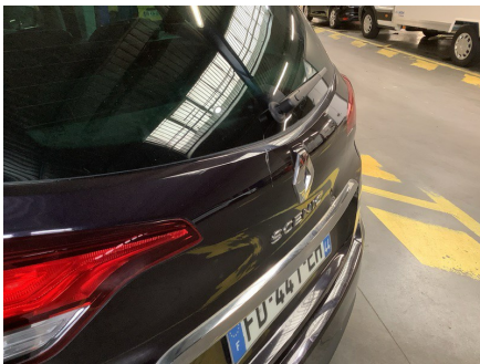
ETAT EXTÉRIEUR - ARRIÈRE Hayon; Enfoncé; Avec dommage de peinture
