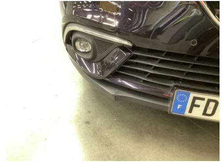
ETAT EXTÉRIEUR - AVANT Pare-choc AV; Enfoncé; 1 à 2 éléments < à 10mm
