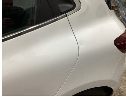
ETAT EXTÉRIEUR - CÔTÉ CONDUCTEUR Panneau ARG; Enfoncé; Avec dommage de peinture
